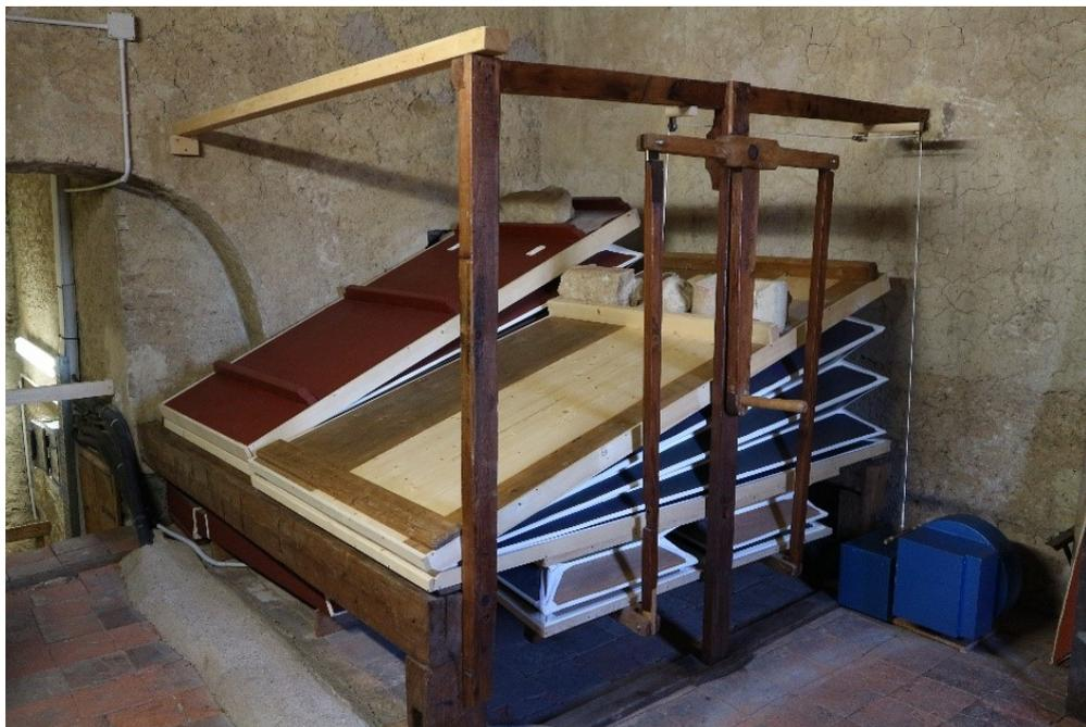
Fig. 19 – Manticeria dopo il restauro con applicazione di nuovo elettroventilatore e nuova valvola "a tendina".
