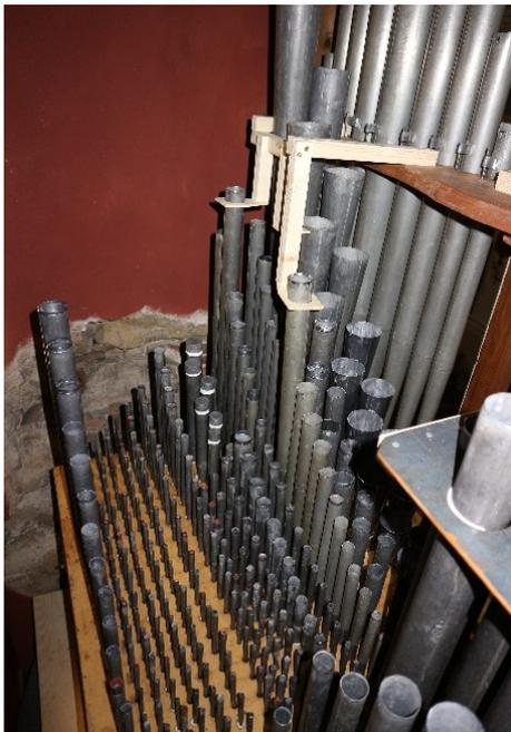
Fig. 23 – Particolare del materiale fonico dopo il restauro con risanamento delle pareti
