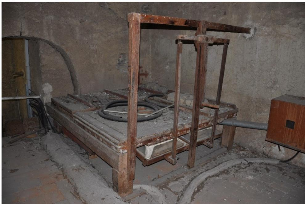
Fig. 18 – Manticeria prima del restauro e vecchio elettroventilatore
